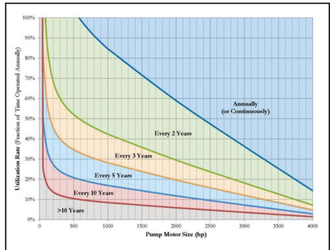
Figure 2: GUIDELINE FOR PUMP TESTING FREQUENCY
